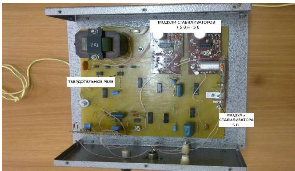
Рис. 2 – Передающее устройство с снятой крышкой (вид сверху)
