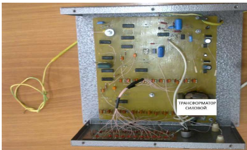
Рис. 2 – Передающее устройство с снятой крышкой (вид сверху)
