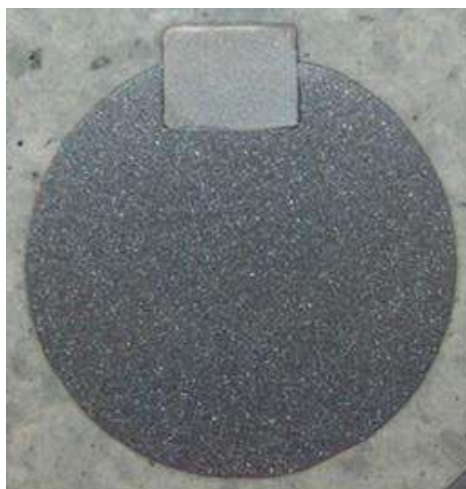
Рисунок 2 - Внешний вид поперечного сечения шпоночного соединения после ЭМО (x2)
