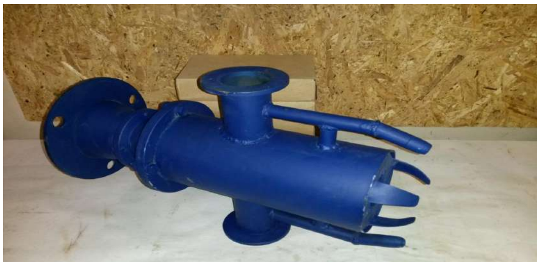
Рисунок 2. - Исследуемый лабораторный образец всасывающего струйного наконечника землесосной установки
