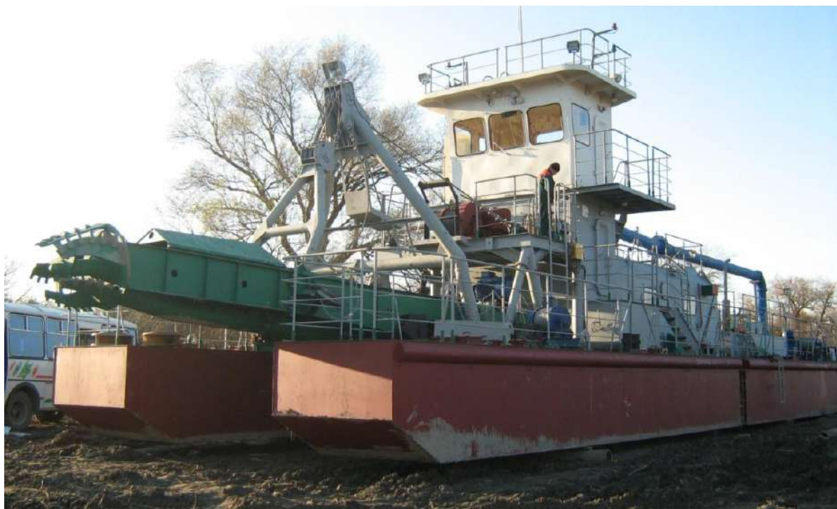
Рисунок 4 – Испытание эжекторно-землесосного снаряда на Дельтовом канале Республики Дагестан.
