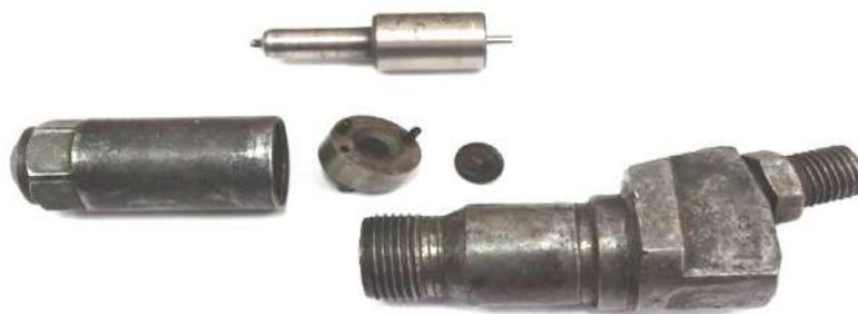
Рисунок 1 – Детали форсунки дизельного двигателя КАМАЗ
