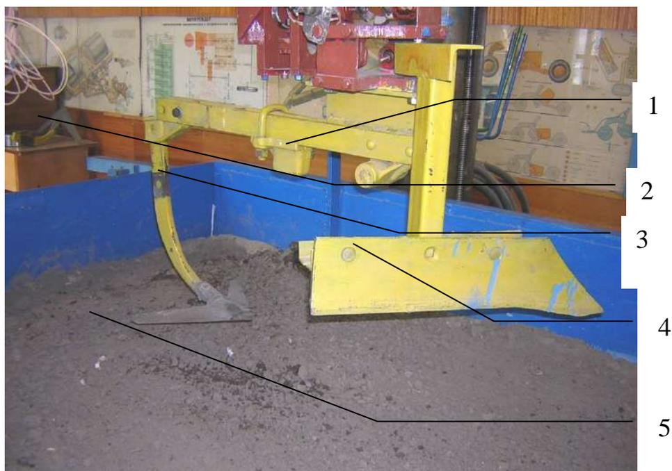
Рисунок 1. Конструкция лабораторной установки комбинированного почвообрабатывающего агрегата: 1 – рама; 2 и 3 – зажим; 4 – стойка плужно-отвального лемеха; 5 – рыхлитель.
