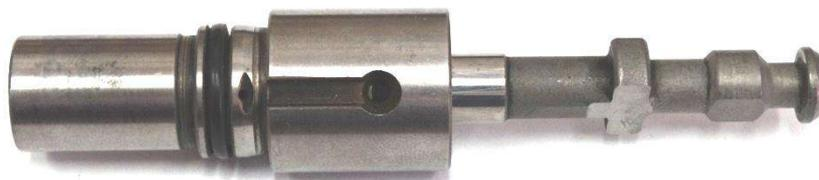
Рисунок - 2. Детали ТНВД дизельного двигателя КАМАЗ
