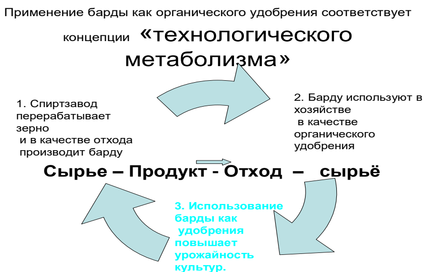
Рисунок 2 – Концепция «технологического метаболизма» на примере спиртовой промышленности
