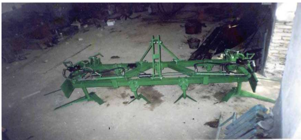
Рисунок 1 - Культиватор с приспособлением для междустовой обработки
