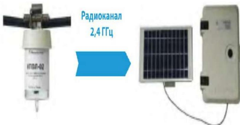
Рис.2 – Индикатор повреждения (слева) и трансмиттер (справа)
