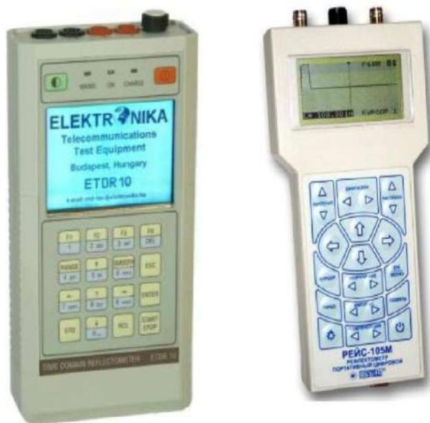
Рис.2 – Современные приборы импульсной рефлектометрии (сверху вниз): ETDR 10, «Рейс-105М», RIF-9
