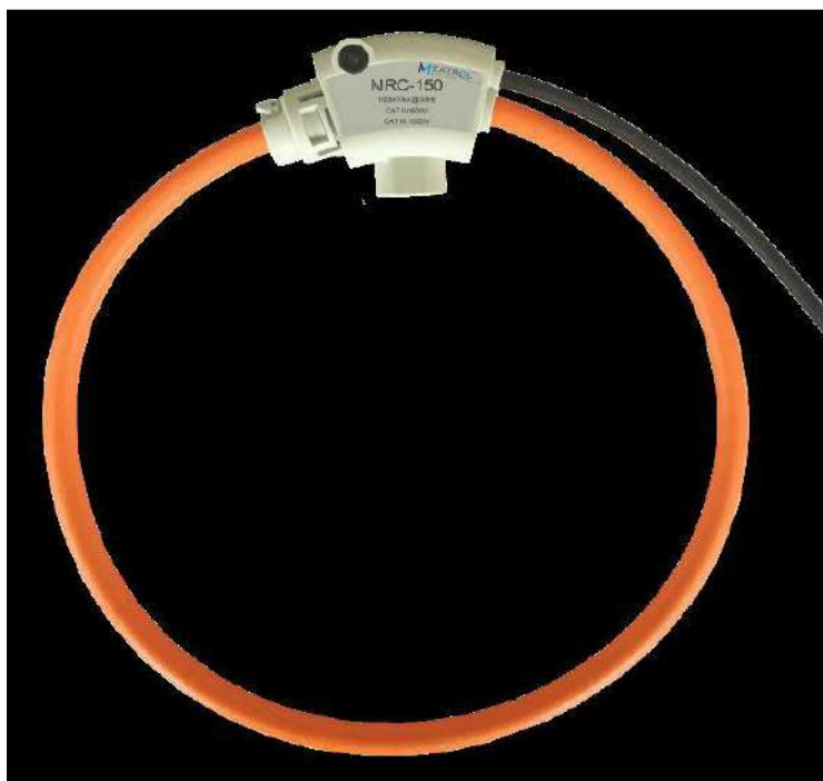
Рисунок 2 - Внешний вид катушки Роговского серии NRC
