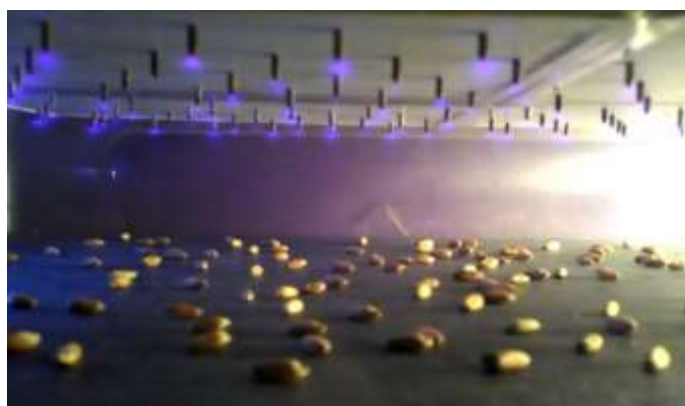
Рисунок 1 – Обработка семян в тлеющем разряде атмосферного давления
