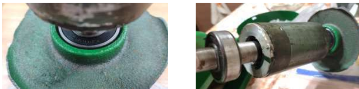
Рисунок 2 – Дефекты, обнаруженные при испытании дробилки: а – в крышке электродвигателя; б – на роторе электродвигателя
