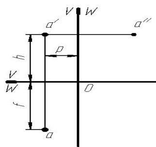
**3. Укажите комплексный чертеж отрезка прямой общего положения?**
