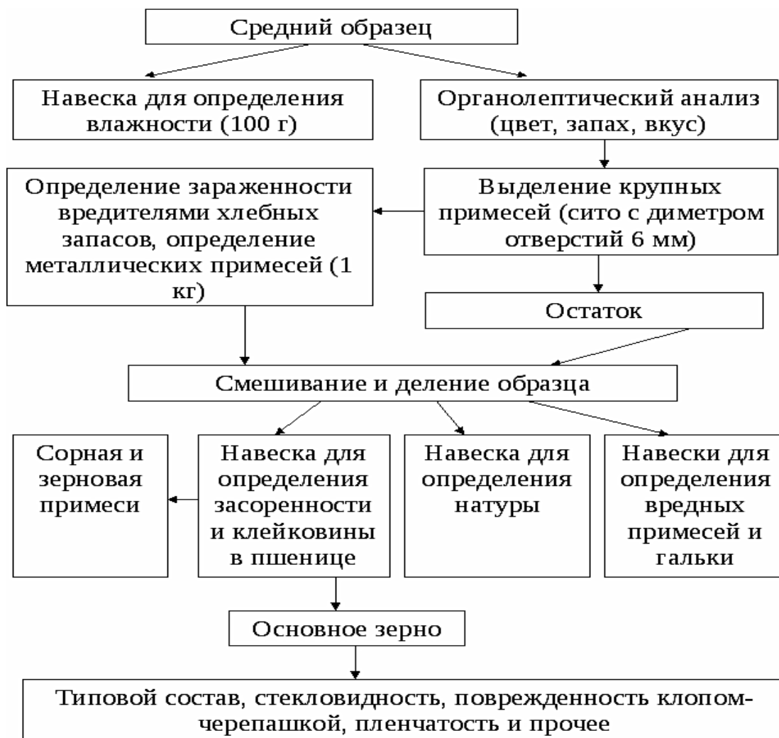
Рисунок Б 1 – Порядок проведения анализа зерна
