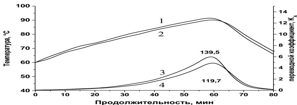
Рисунок 3 – Кривые изменения температуры (1,2) и летальности (3,4) при пастеризации сока сливового с мякотью и сахаром в стеклососуде объемом 3.0 л по ускоренному режиму с переворачиванием банок в процессе термообработки
