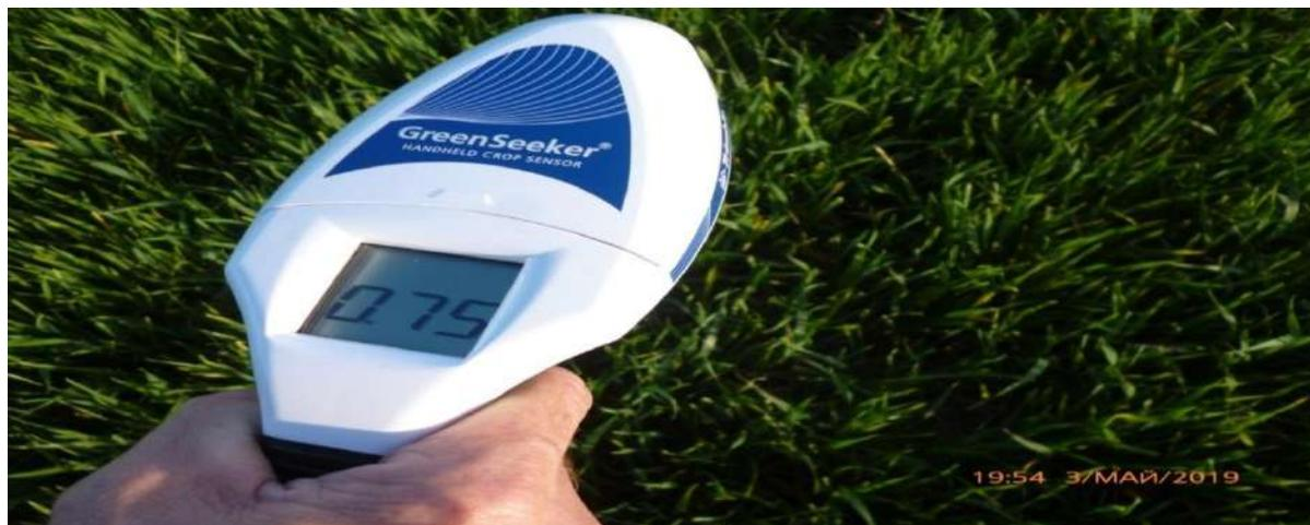
Рисунок 1 - Измерение вегетационного индекса (*NDVI*) посева озимой пшеницы портативным устройством (ручной сенсор) *GreenSeekerHandheldCropSensor, ModelHCS - 100*
