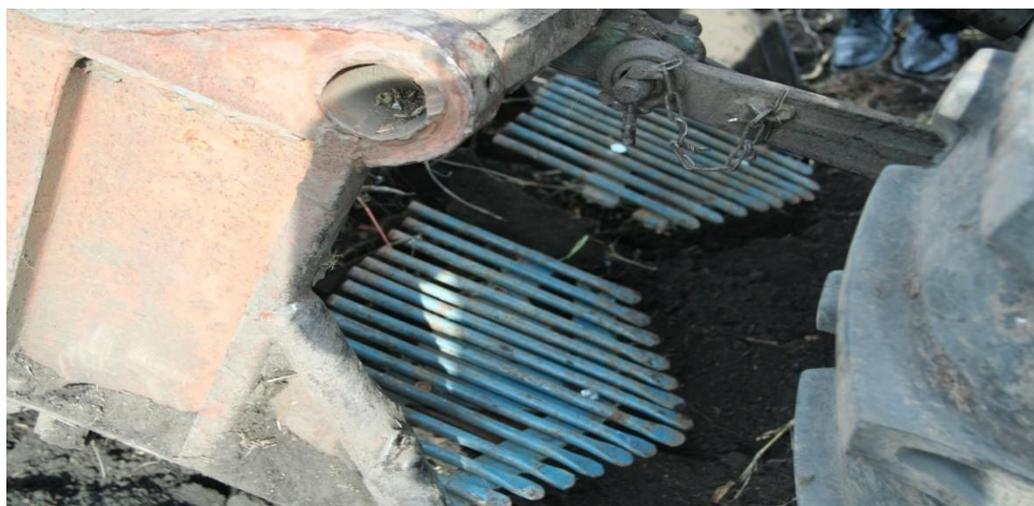
Рисунок 1 – Общий вид пруткового подкапывающего рабочего органа
