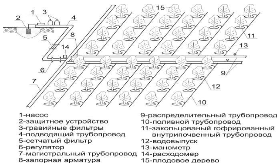
Рисунок 1 - Система внутрипочвенного мелкоструйчатого локального орошения
