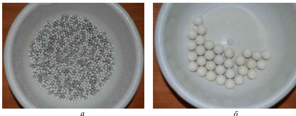
Рисунок 2 - Мелющие тела шаровой мельницы: а) диаметром 6 мм; б) диаметром 31 мм
