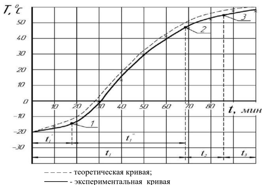
Рисунок 4 – Графики процесса разогрева охлаждающей жидкости двигателя КамАЗ-740: 1 – точка перехода от начального к эффективному подогреву охлаждающей жидкости; 2 – точка завершения основного этапа подогрева охлаждающей жидкости; 3 – точка перехода к окончанию процесса подогрева охлаждающей жидкости.
