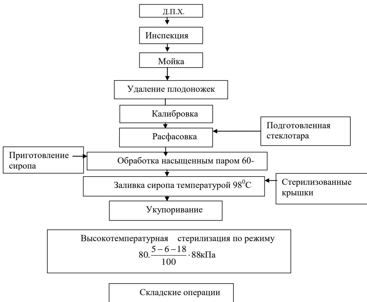
Рисунок 2 – Инновационная технологическая схема производства компота из вишни с использованием импульсного нагрева плодов в банках насыщенным паром и ускоренных режимов тепловой стерилизации
