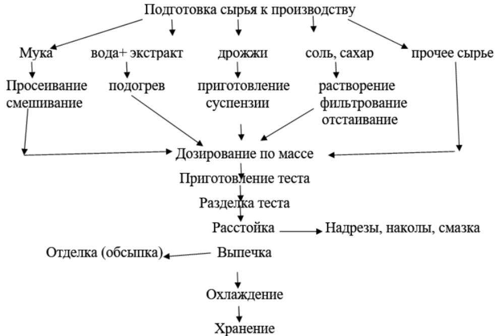
**Рисунок 2. Технологическая схема производства кондитерских изделий с использованием молочных экстрактов из ягод**
