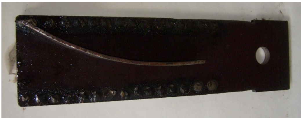
Рисунок 1 - Нож косилки-измельчителя с установленной пластиной
