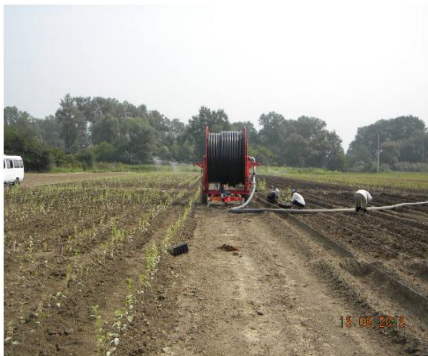
Рис. 12. Полив барабанной дождевальной установкой (произво- Германия) высаживаемых клоновых подвоев косточковых культур
