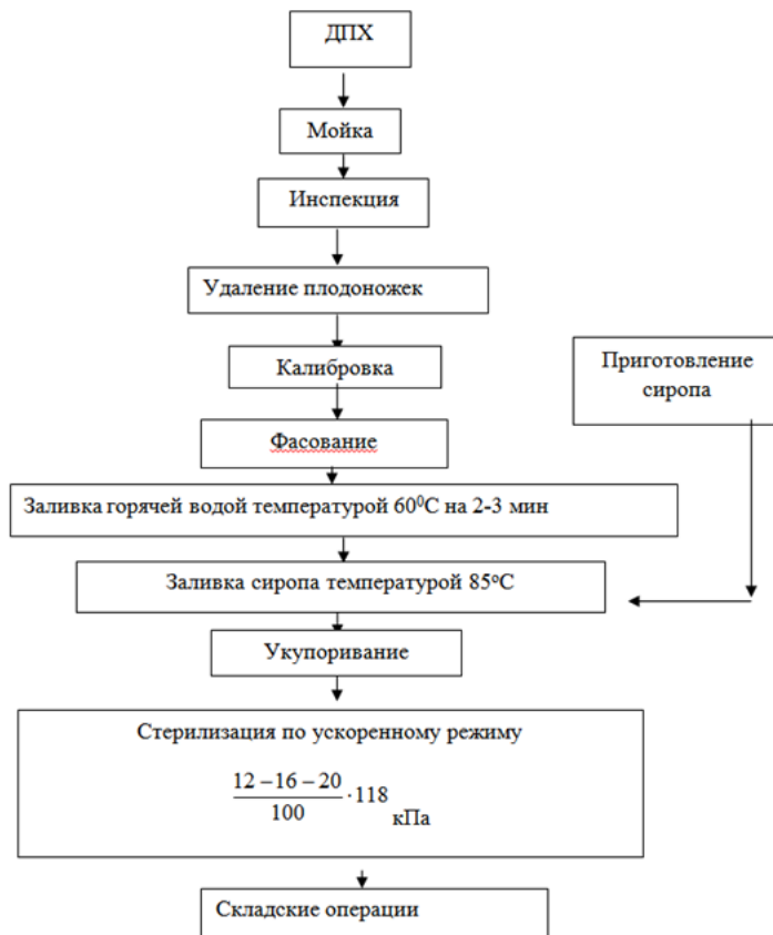
Рис. 3. Инновационная технологическая схема производства компота из черешни в банке объемом 1,0 л с использованием предварительного нагрева плодов в банках горячей водой и ротационно-ступенчатой стерилизации
