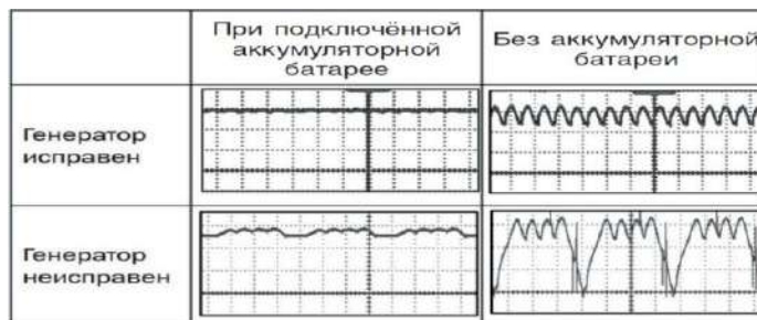
Рисунок 1 – Воздействие аккумуляторной батареи на информативность осциллограмм выходного напряжения автогенераторов
