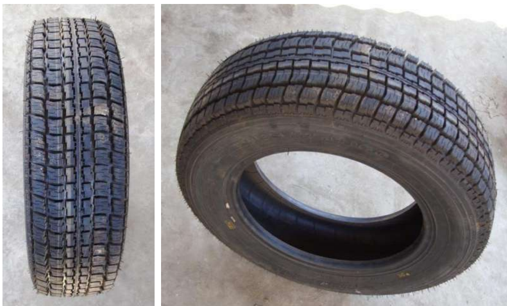
Рисунок 1 - Вид испытуемой шины марки Кама-301 185/75 R16C
